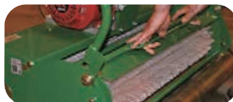
새 카세트를 전면 장치 베어링 스테드에 삽입합니다.
